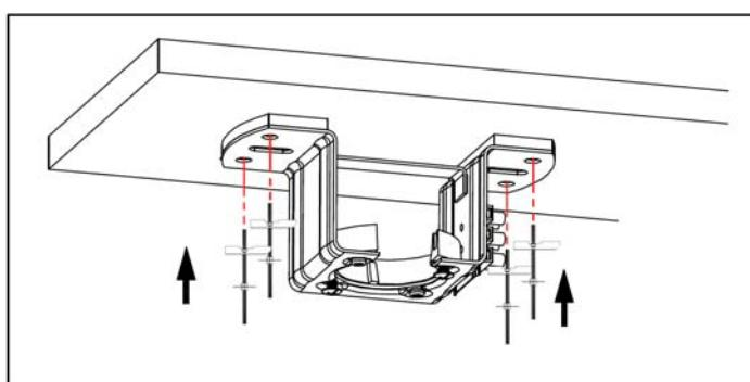
Si el techo es de madera o escayola, es necesario instalar 4 balancines o 4 tornillos autorroscantes para fijar el soporte a techo.
