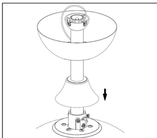
Por último, vuelva a apretar los dos tornillos de fijación y baje la tapa de unión del tubo.
