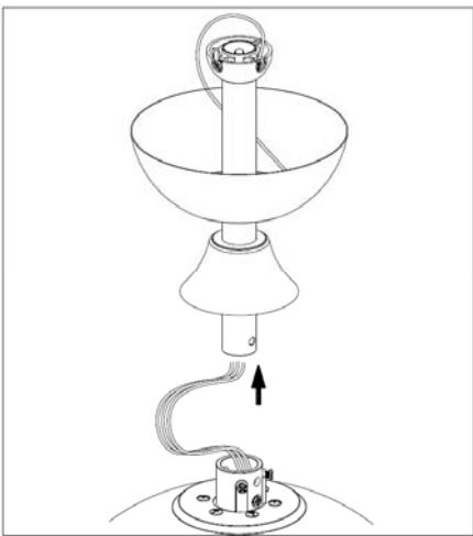
Pase los cables eléctricos y el cable de tierra a través de la varilla.
