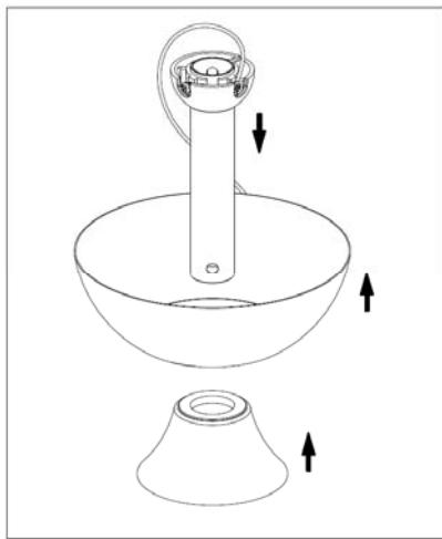
Pase la varilla de enganche a través del florón y la tapa de unión del tubo.
