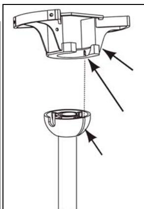
Levante con cuidado el ventilador y coloque la semiesfera en el soporte de suspensión fijado al techo haciendo coincidir la ranura de acoplamiento.
