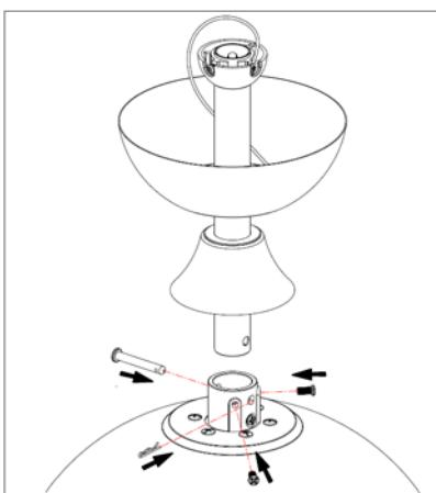
Afloje los dos tornillos de fijación del soporte de la varilla roscada, a continuación, coloque la varilla en el soporte de la varilla.
