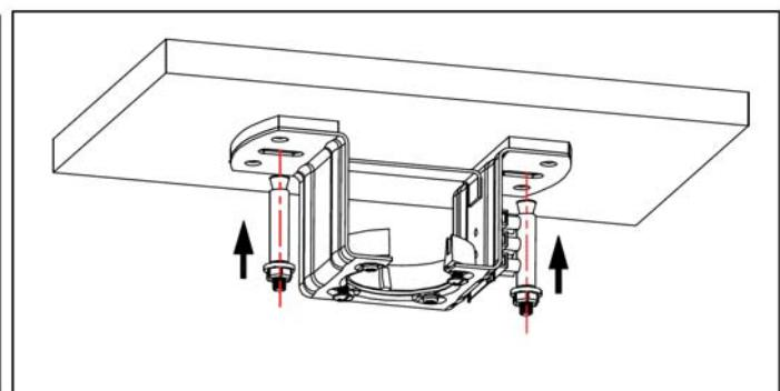
Si se trata de un techo de hormigón, es necesario instalar 2 tornillos de expansión para fijar el soporte a techo.
