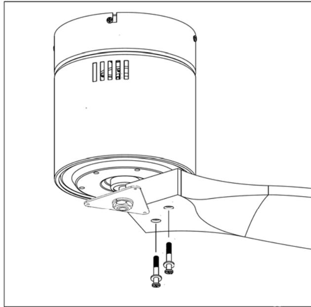
3- Montaje de la placa iluminación. Para montar el plafón metálico fijándolo bajo las aspas.
