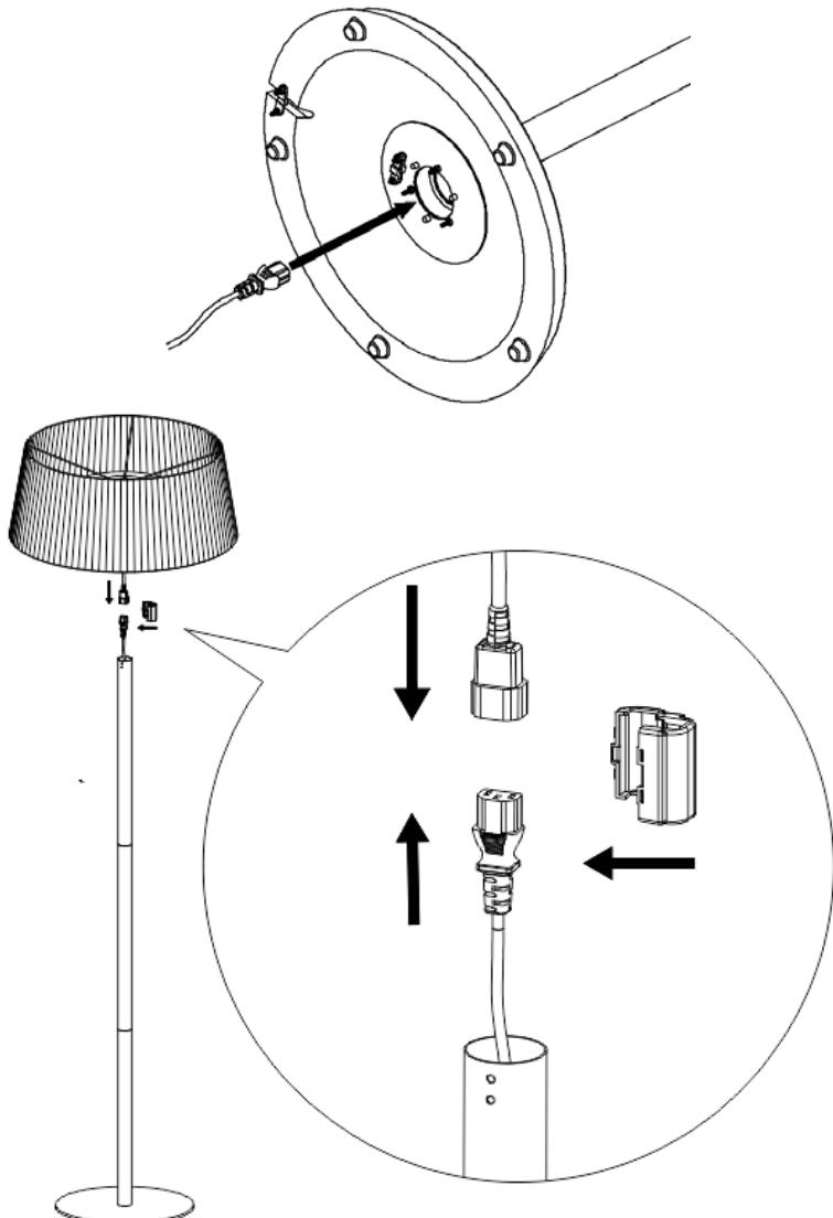
Paso 5: inserte el cabezal de la estufa en el tubo superior y fíjelo en su posición usando los tornillos de 4\*8 mm
