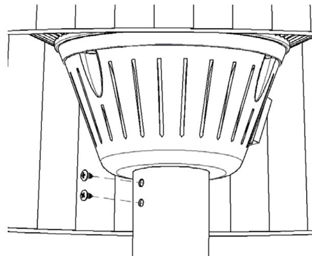
Paso 6: Fije el cable de alimentación en la base usando los tornillos 4\*12.
