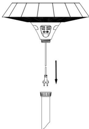
Paso 2: Como se muestra en la figura, monte los tubos sucesivamente enroscándolos en el orden indicado.
