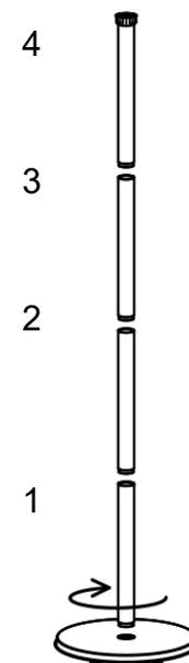
Paso 3: Monte la cabeza del calentador con el tubo roscándolos juntos mediante la arandela de ensamblado.
